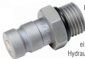
Das System „Flat Face“ besticht durch kompaktes Design und ist schnell und leicht zu reinigen, weil kein Gewinde vorhanden ist. Der Betriebsdruck beträgt nach Norm 400 bar. Flat Face ist eine Diagnose-Kupplung, die in Verbindung mit Hydraulikölen eingesetzt wird. Die Kupplungsseite ist genormt nach ISO 15171-1. Sie bietet hohen Korrosionsschutz und hält einem 1.000-Stunden-Salzsprühtest stand.
