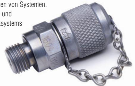
Die Original Minimesse® Kupplung 1604 eignet sich durch ihren großen Innendurchmesser DN4 für das schnelle Befüllen oder Entleeren von Systemen. Drucküberwachung, Kontrolle und Probeentnahme des Hydrauliksystems im laufenden Betrieb sind ebenso möglich.
